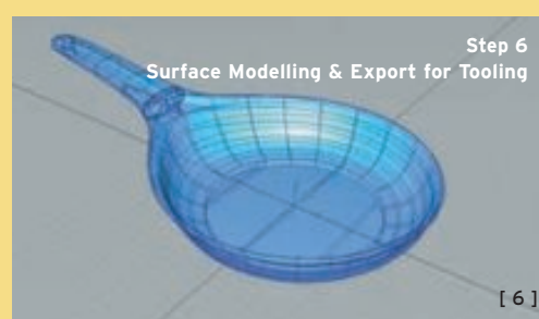
Vor dem Werkzeugbau werden virtuell die exakten Aussenflächen der Pfanne konstruiert. Diese Daten sind für die fehlerfreie Produktion unumgänglich.
