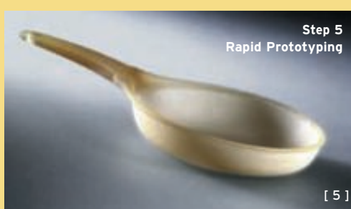
Die Originaldaten setzen wir von robotmech in kürzester Zeit (ONE DAY-SERVICE) in überzeugende Modelle um, die, wie es im speziellen Fall von «Mami» war, zu Ergonomie-Studien (Griff-Handling) verwendet werden. Korrekturwünsche seitens des Kunden werden zunächst manuell und dann über CAD berücksichtigt.
